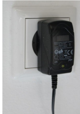
Netzteil mit grüner Kontroll-LED
