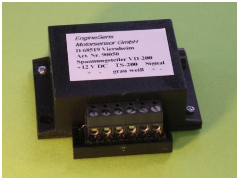
Spannungsteilerschaltung VD-200 Art.-Nr. 90050
