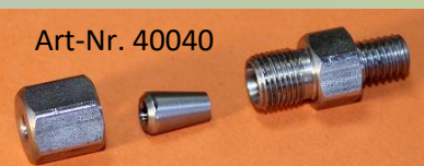
Klemmringverschraubung M6x1,0 für Thermolemente Ø 3mm compression fitting
