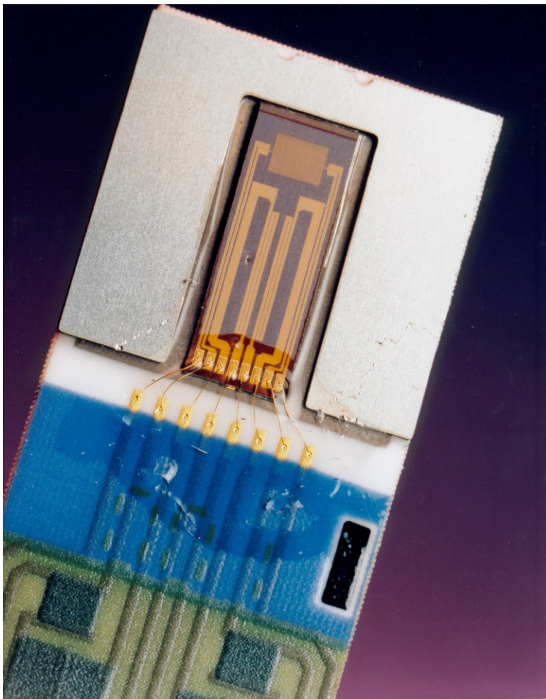
<Typisches Heißfilmanemometer mit 2 Heizern und 2 Temperaturfühler auf Membran Foto von Heraeus Sensor Technology >
